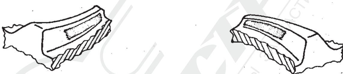
Рис. 4-8. Типовое пятно прилегания с обеих сторон зуба под малой нагрузкой.
